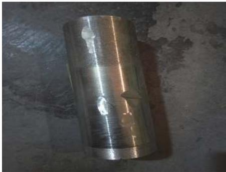
图 1 Ti-Ni 合金铸锭
