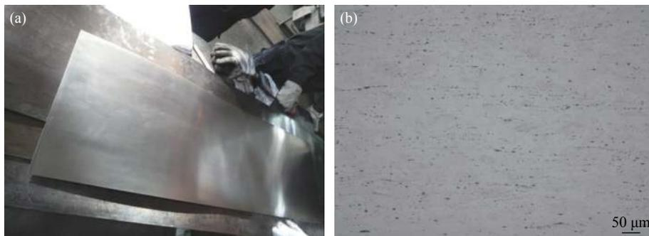
图 4 Ti-Ni 合金: (a) 薄板成品; (b) 冷轧态金相照片
