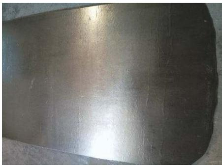
图 3 Ti-Ni 合金热轧板
