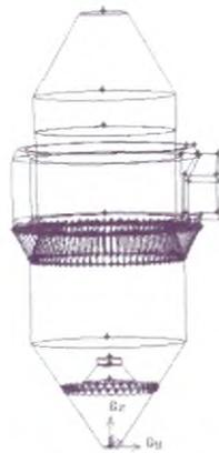
图1 干熄炉几何模型示意图
