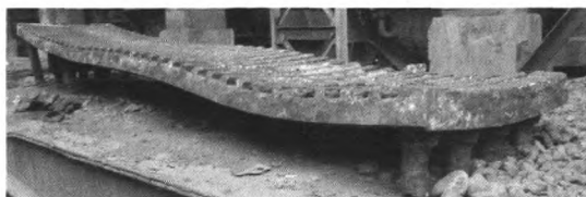
图4 S1段破损的长冷却壁
