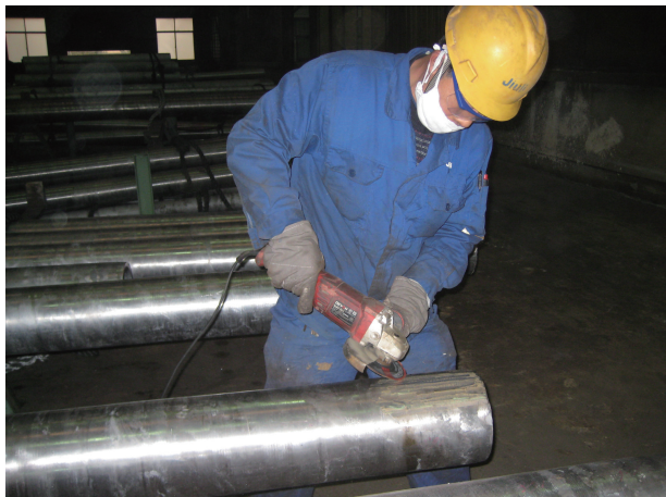
图2 手动式电动磨光机在修磨
