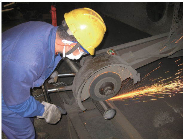
图3 倒挂式磨光机在修磨
