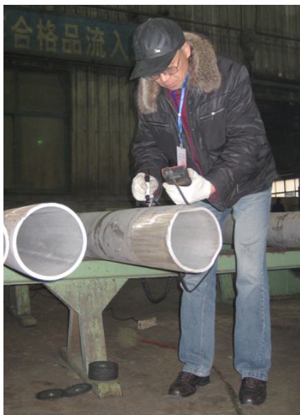
图4 抽检员在测管壁厚度
