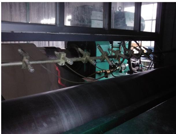
图4 卷取机前的自动油雾喷洒装置
