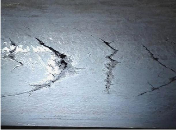
图1 试样宏观开裂样貌
