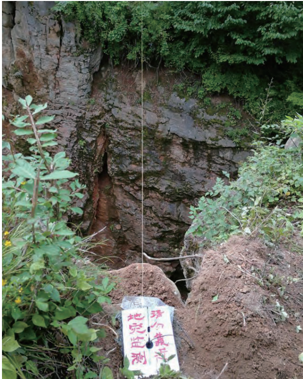
图3 拉线式位移计安装图
