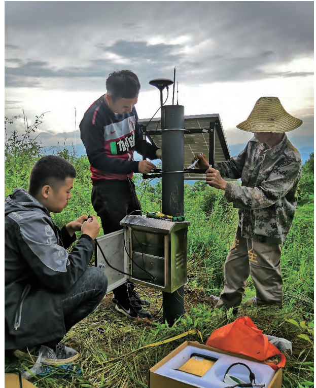
图4 GNSS变形监测点安装施工图
