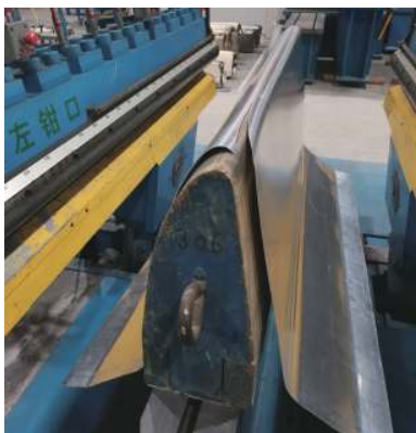
图2 传统拉伸成形过程中出现的断裂缺陷
