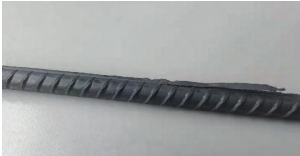
图1 螺纹钢折叠宏观情况
